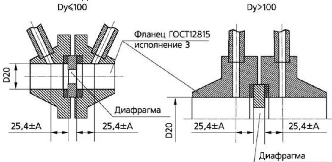
$A = 0,5$  мм при  $m > 0,36$  и  $58 \text{ мм} < D20 < 150$
