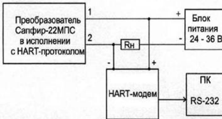
Рис. 2.2. Схема подключения модема, исполнение обычное (вариант)
