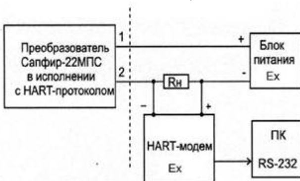
Рис. 2.3. Схема подключения модема, исполнение Ex
